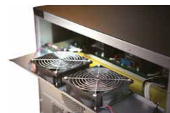
Ventilador redundante lo que mejora la fiabilidad del sistema.
